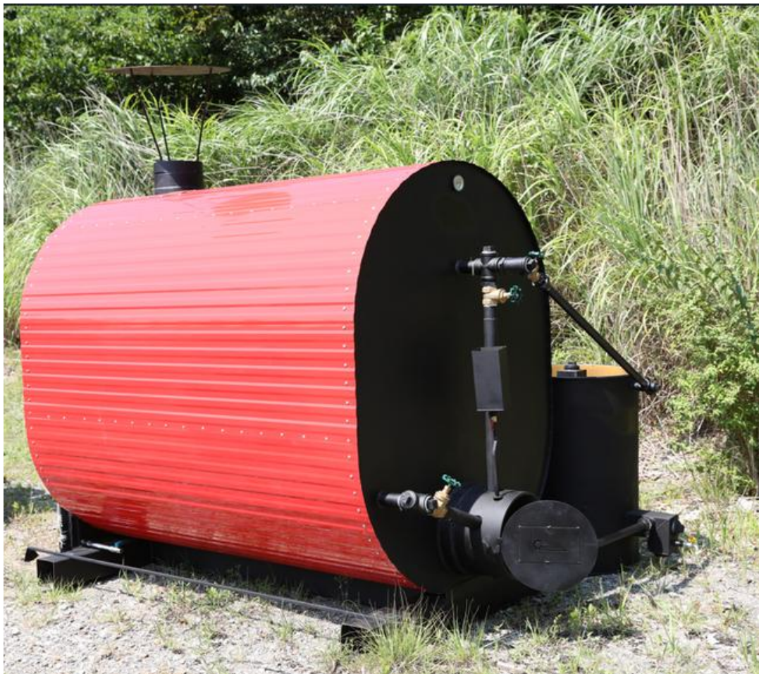
特願No.2025-42198 ロケットストーブを用いた間接加熱式炭化装置 2025/03/17特許出願 受領済
